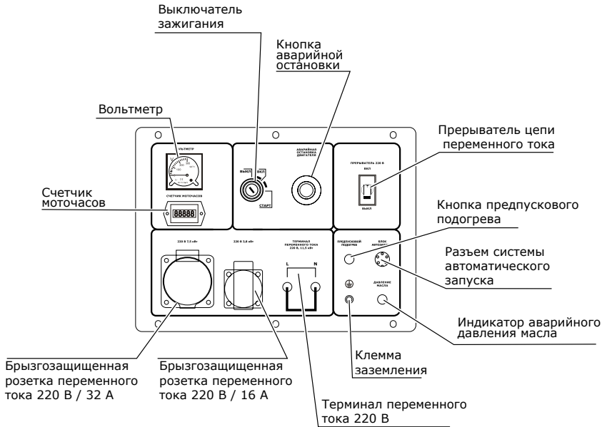
Рис. 6. Схема панели управления генераторов УГД-11500ЕТ и УГД-15000ЕТ
