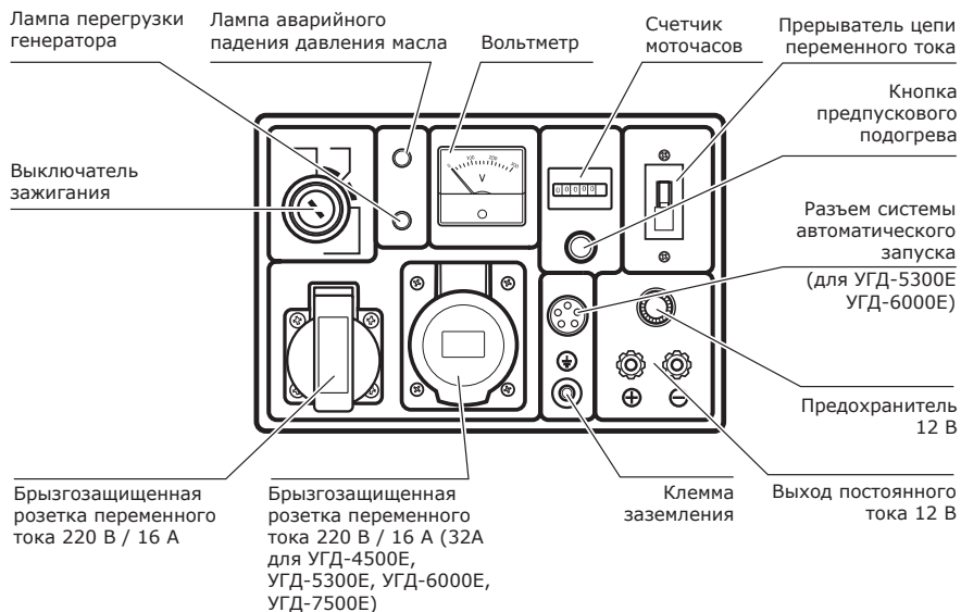
Рис. 2. Схема панели управления генераторов УГД-3000Е, УГД-4500Е, УГД-5300Е, УГД-6000Е, УГД-7500Е.
