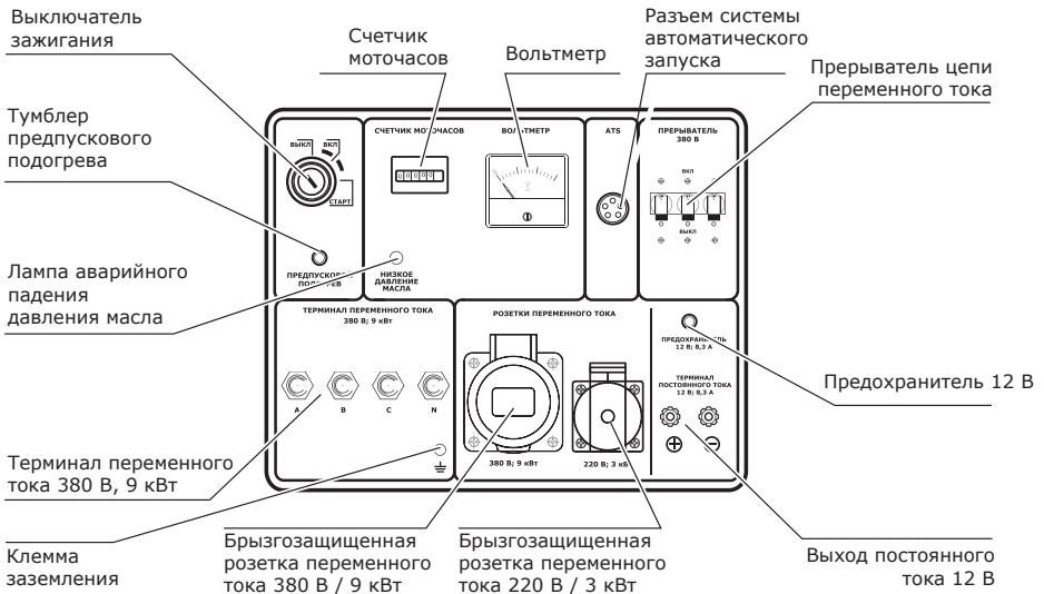
Рис. 5. Схема панели управления генератора УГД-1000ЕТ
