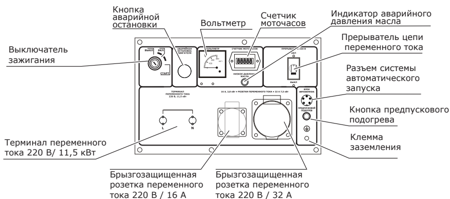
Рис. 6. Схема панели управления генератора УГД-11500ЕТ
